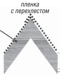
Конек мансардной крыши с применением мембраны
